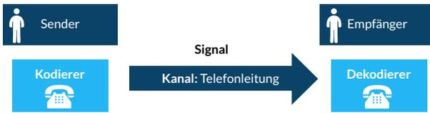
In dem oben dargestellten Schema sehen Sie, wie das Modell bei einem Telefongespräch aussähe: Der Sender kodiert seine Nachricht mit Hilfe des Telefons und dieses Signal kommt über die Telefonleitung (den Kanal) beim Telefon des Empfängers an. Fehler könnten in allen dargestellten Komponenten auftreten: z.B. könnte das Telefon des Empfängers defekt sein oder die Telefonleitung nicht funktionieren. Das Modell lässt sich ebenfalls auf direkte gesprochene Sprache übertragen:
